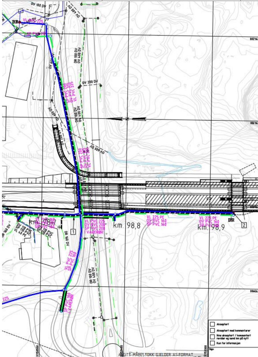
Figur 5-11: Omlegging kommunal VA-anlegg. Vann og avløp til stasjon
