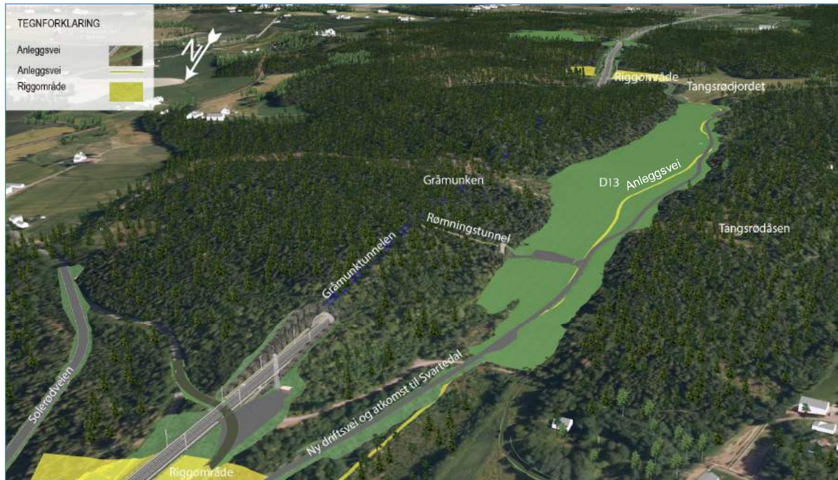
Figur 4-46: Delstrekning 6 – Gråmunktunnelens nordre portal og deponi D13 sett nordfra. Med anleggsfasen (fra 3D-modell)
