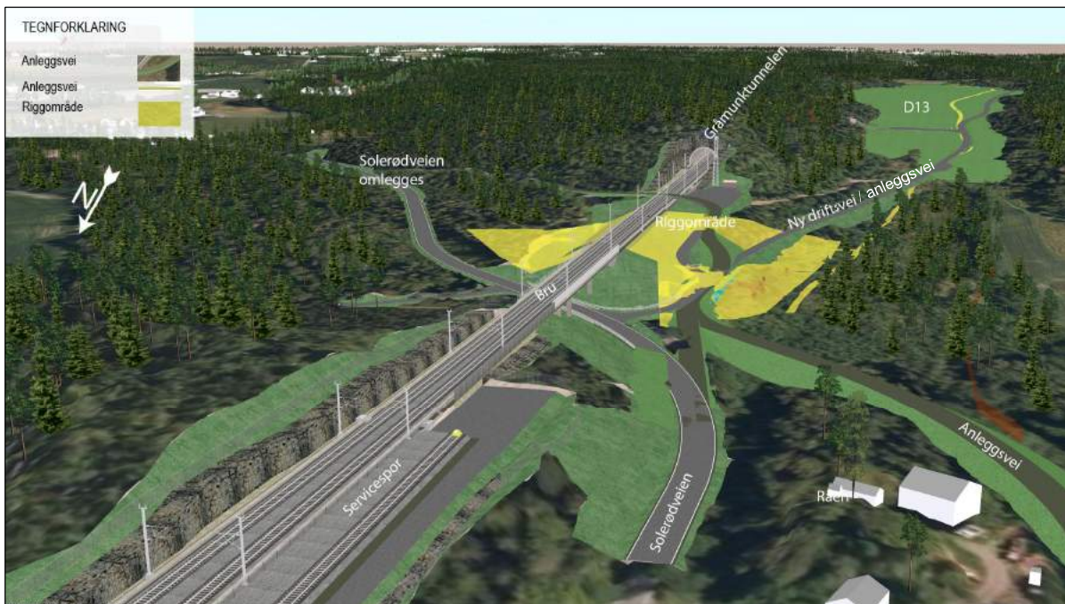
Figur 4-38: Delstrekning 5 - Søndre del ved bru over Solerødveien, med anleggsfase (fra 3D modell)
