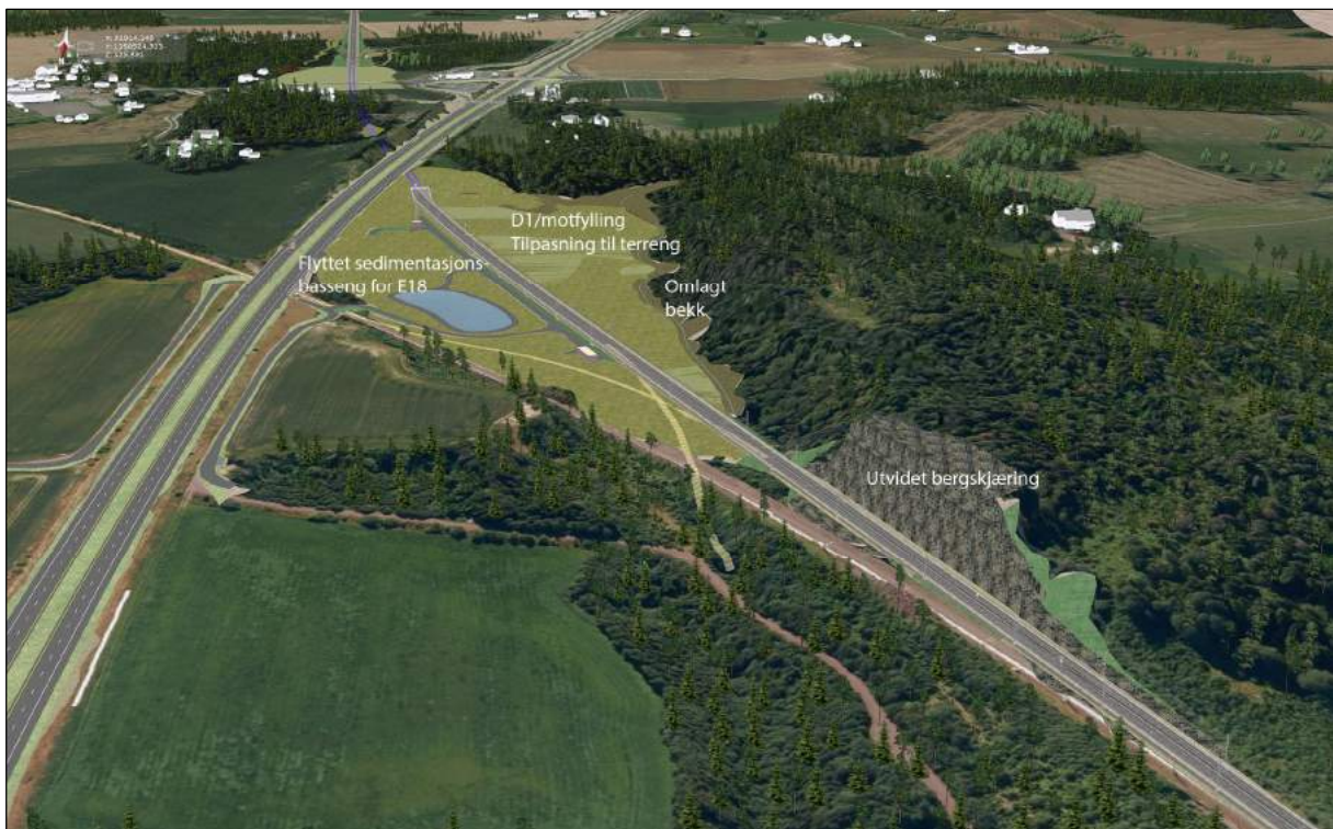
Figur 4-4: Delstrekning 1 - utvidet bergskjæring og D1/motfylling med tilpasning til terreng (Illustrasjon fra 3D-modell)
