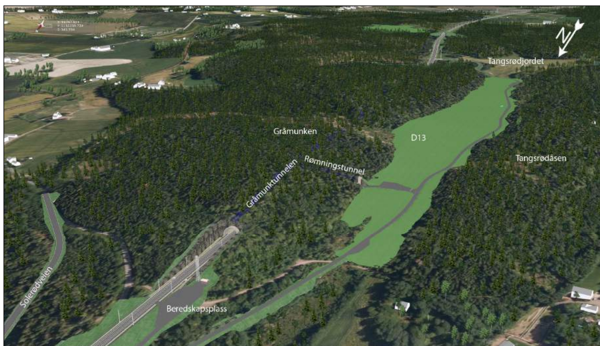
Figur 4-30: Delstrekning 6 – Gråmunktunnelens nordre portal og deponi D13 100%-alternativet sett sørover (Illustrasjon fra 3D-modell)
