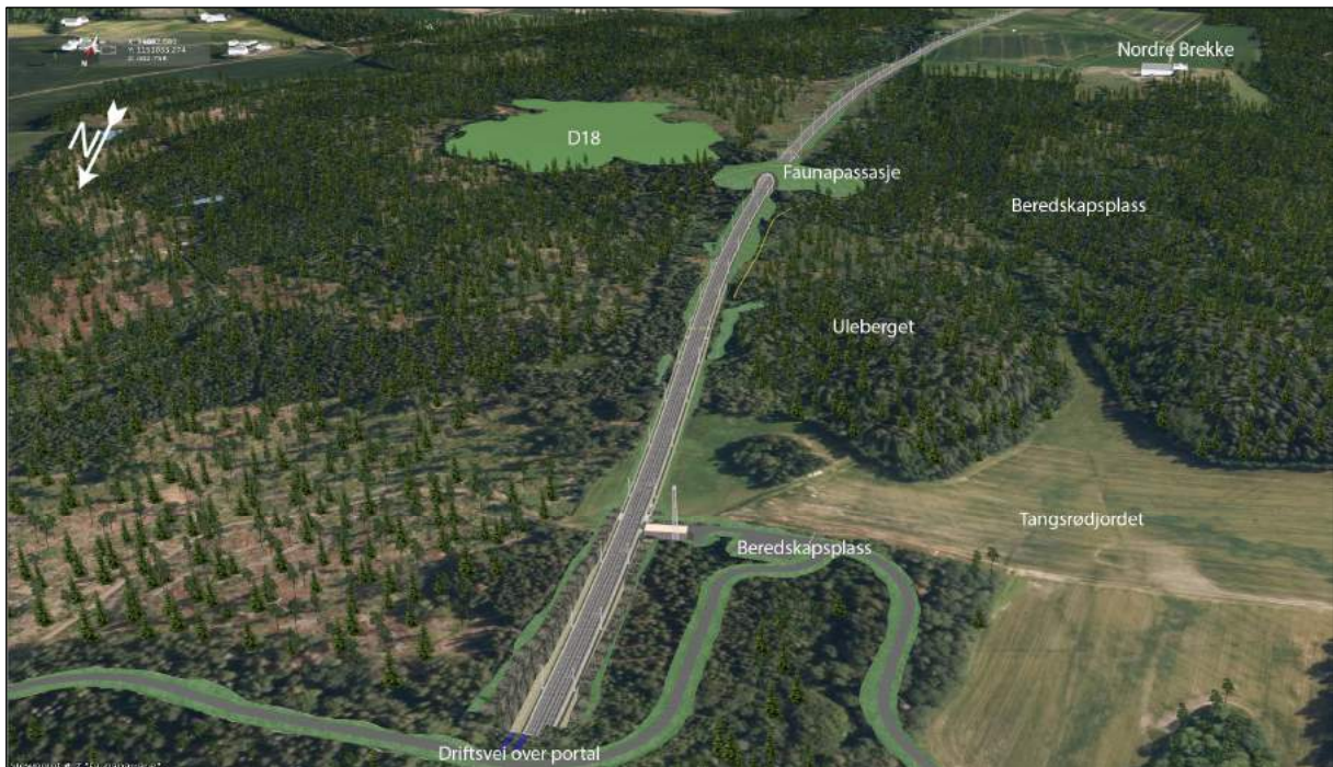
Figur 4-34: Delstrekning 7 – Dagsonen fra Tangsrørdjordet og sørover med faunapassasje sett sørover (Illustrasjon fra 3D-modell)
