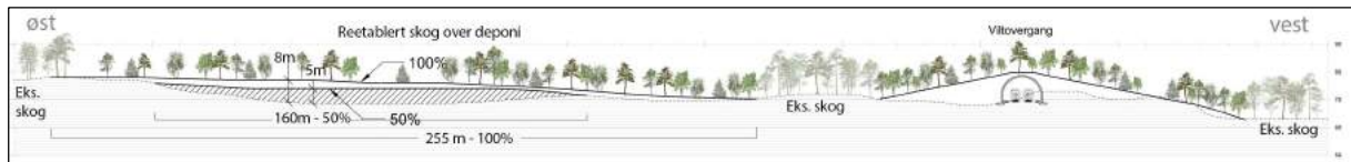
Figur 3-74: Snitt for alternativ med reetablert skog (Snittlinje til Snitt A-se Figur 3-69)
