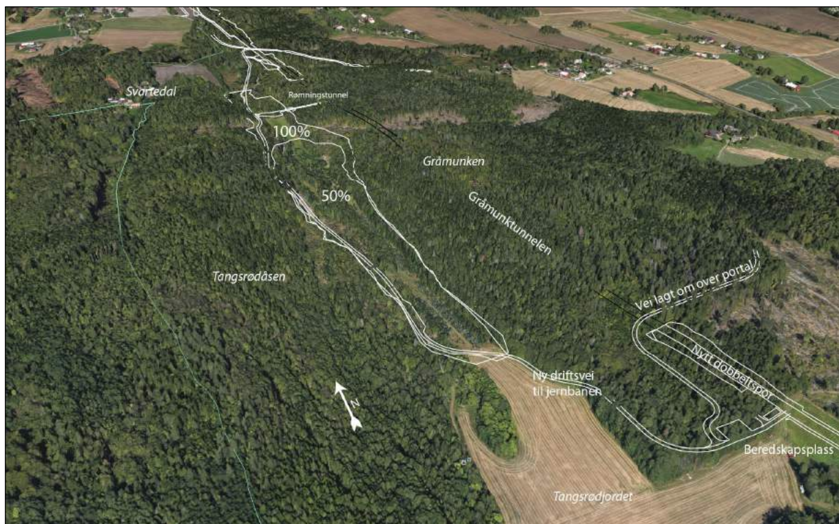
Figur 3-42: Avgrensning av Deponi D13 med ny jernbane og tilhørende veisystem (Fotogrunnlag: Google Earth)
