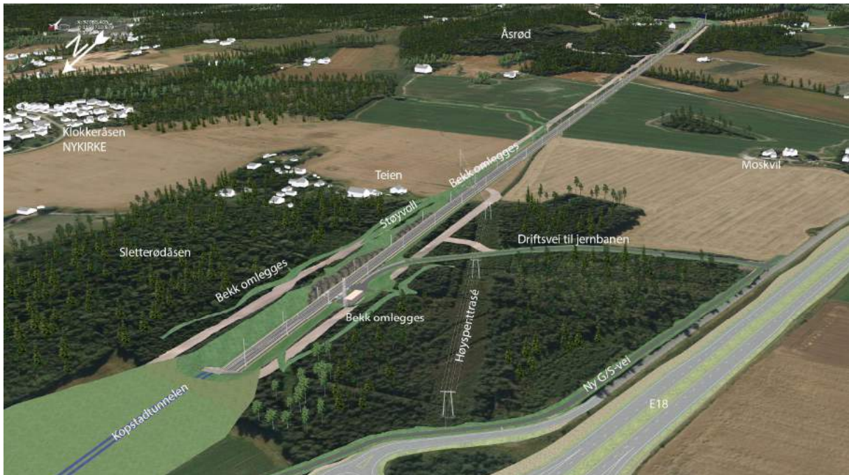
Figur 4-11: Delstrekning 3 – Dagsone i dyp skjæring og på terreng sør for Kopstadttunnelen (Illustrasjon fra 3D-modell)
