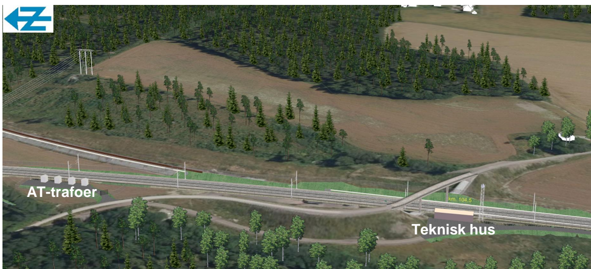
Figur 6-8: AT-trafoer og teknisk hus ved Barkåker, sett mot øst
