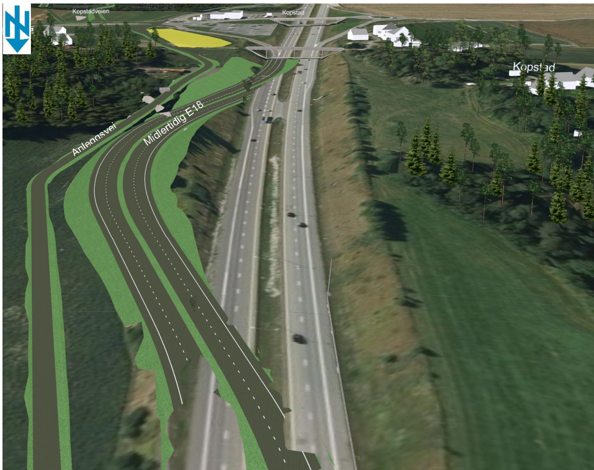
Figur 4-1: Midlertidig trasé for E18, sett mot sør
