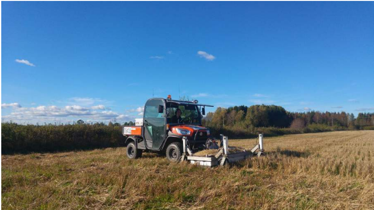
Figur 2 - 16-kanals georadarsystem av typen MALÅ MIRA på Moskvil Nordre i Horten kommune. Foto: EN/NIKU.
