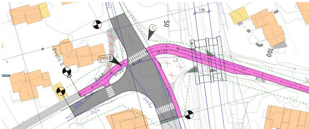
Figur 12: Utsnitt av plantegning for GS-undergang Hognestadvegen ved Nubben
