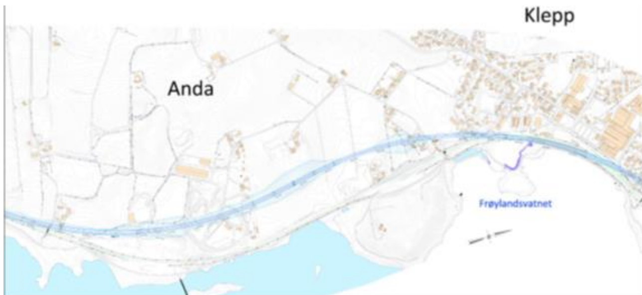
Figur 38: Plattformer og gjennomkjøringshastighet 160 km/t. Forkastet da den ga store inngrep både nord og sør for Klepp stasjon
