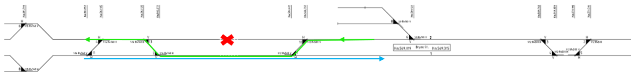
Figur 2: Eksempel som viser at ved aktiviteter i et spor (rødt kryss) kan det være mulighet å kjøre forbi stedet for tog i begge retninger
