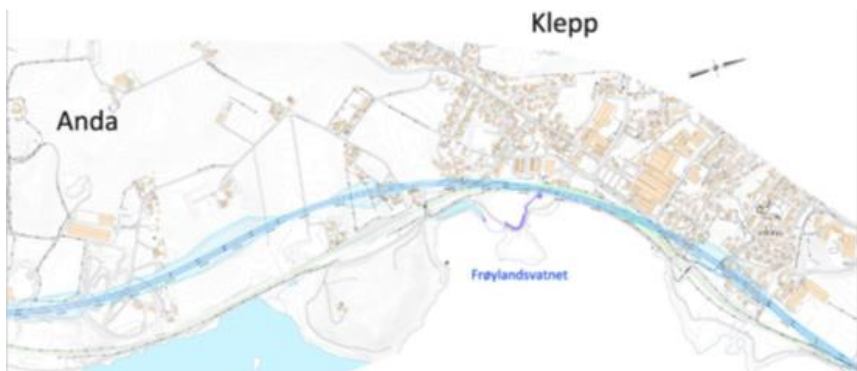
Figur 40: Linje ved gjennomkjøringshastighet 160 km/t ved nedleggelse av togstopp. Forkastet da det ble besluttet å opprettholde stopp på Klepp.
